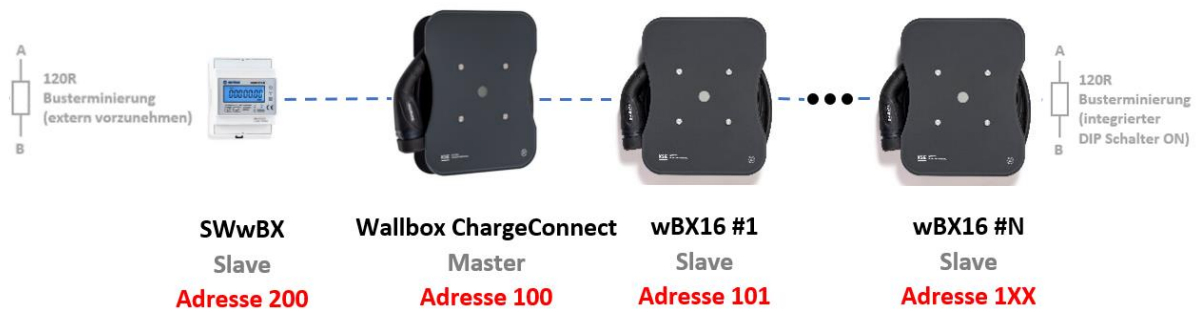
Abbildung 35: Wallboxen mit Lademanagement in Verbindung mit Stromwandler zur Lastregelung
