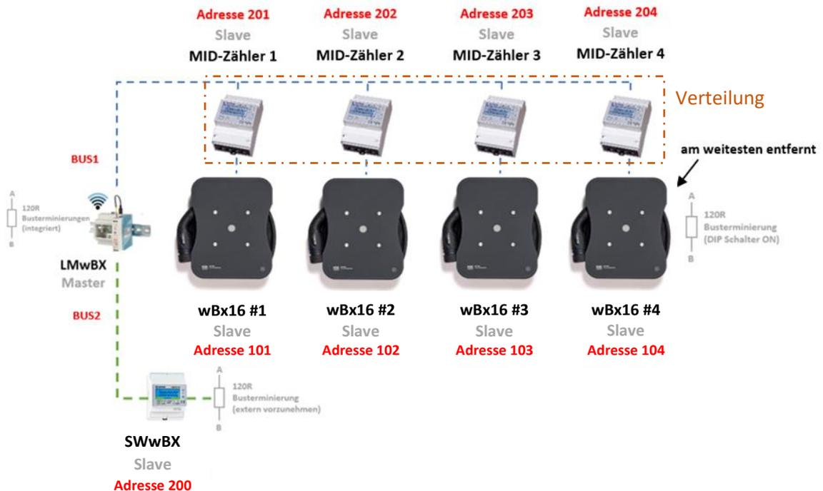
Abbildung 37: Variante 2 Wallboxen mit Lademanagement mit Stromwandler und MID-Zählern in Bus-Verdrahtung
