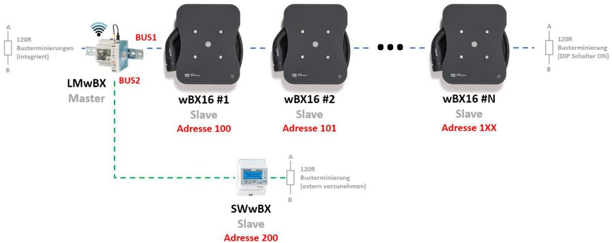
Abbildung 35: Wallboxen mit Lademanagement in Verbindung mit Stromwandler zur Lastregelung
