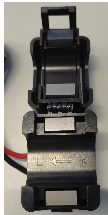
Abbildung 3: Angabe zur Einbaurichtung (Haus)K → L(Netz)
