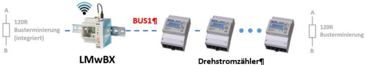
Abbildung 1: Drehstromzähler an LMwBX
